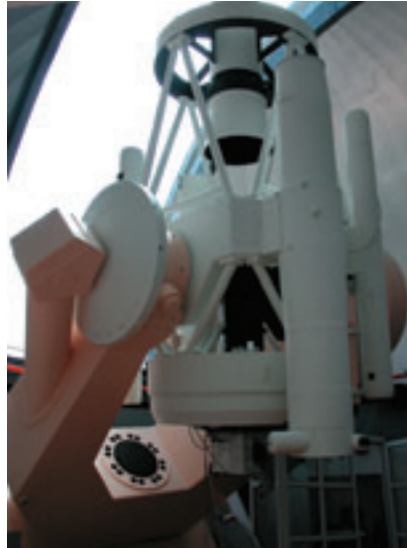
TÜBİTAK Ulusal Gözlemevi'ndeki 150 cm ayna çaplı teleskop. Büyük çaplı teleskoplar, genellikle Cassegrain tipidir.
