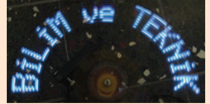
Şekil 8: DC motor ile devreyi çalıştırma
