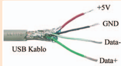
Şekil 4: USB kablunun iç kısmı
