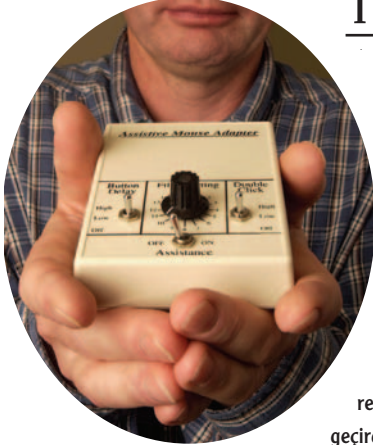
Fareyle bilgisayar arasında takılan bu cihaz, elleri titrediği için bilgisayar kullanamayanların bu sorununu ortadan kaldırmayı hedefliyor.
