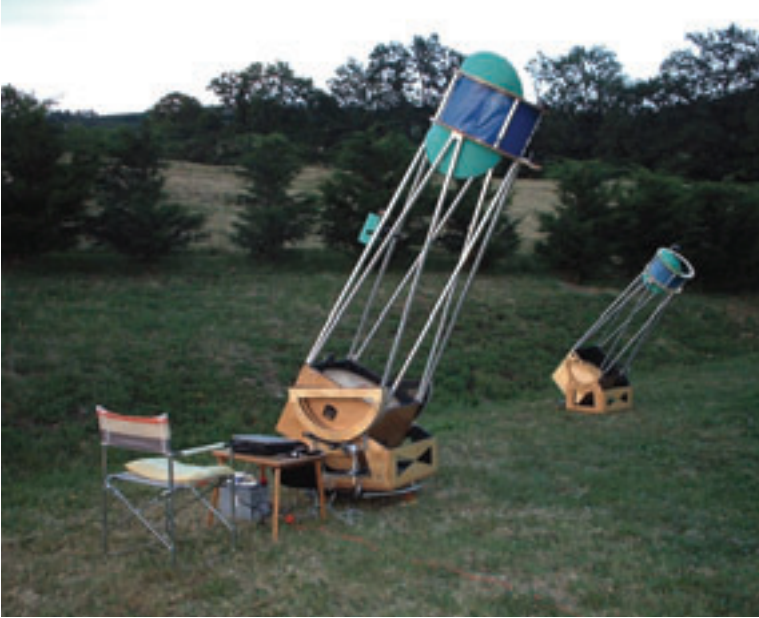
Basit, kullanımı kolay ve ucuz bir teleskop kurgusu olan Dobson kurgusu, büyük çaplı teleskopa sahip olmak isteyen amatör gökbilimciler arasında çok yaygın olarak kullanılıyor. Bu kurgu, Newton tipi teleskoplarda kullanılıyor.
