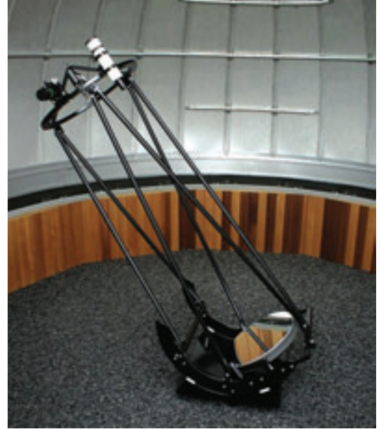
Basit, kullanımı kolay ve ucuz bir teleskop kurgusu olan Dobson kurgusu, büyük çaplı teleskopa sahip olmak isteyen amatör gökbilimciler arasında çok yaygın olarak kullanılıyor. Bu kurgu, Newton tipi teleskoplarda kullanılıyor.
