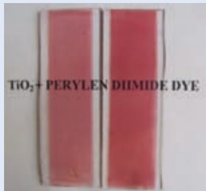
Şekil 4. Nanomorfolojik yapıda saydam TiO 2 üzerine absorblanmış perilendiimid boyar maddesi (Yazılar cam tabakasının altında).
