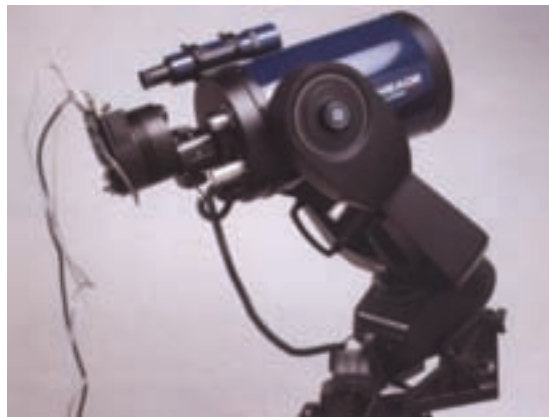
Değişen yıldız gözlemi yapmak, gama ışını patlamalarını gözlemlemek ya da Güneş-dışı gezegen keşfedebilmek için gereken donanım: Teleskop ve CCD kamera. Kuyruklu yıldız, nova ya da süpernova keşfetmek içinse yalnızca bir teleskop yeterli.
